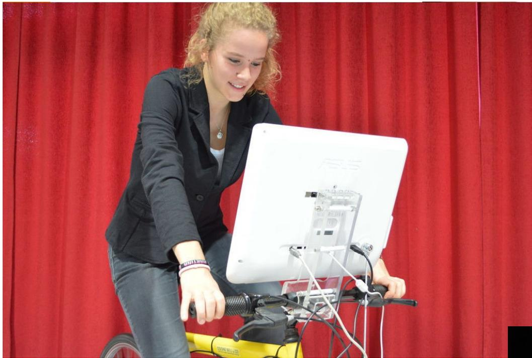
Con un microcontroller Arduino, una connessione ad Internet e le API di Google si pedala virtualmente attraverso le Street View di Google Maps con la simulazione della pendenza nel freno elettromagnetico dell'home trainer
